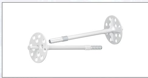
Dämmstoffhalter aus Polypropylen Copo (Dübelhülse) und PA GF verstärkt (Kunststoffnagel) zur mechanischen Befestigung auf unsicherem Untergrund. Montage: Nach dem Erstellen des Bohrloches wird der Dübel durch den Dämmstoff ins Bohrloch gesteckt. Anschließend wird der Kunststoffnagel mit einem Hammer in die Dübelhülse eingeschlagen. Geprüft nach ETA - 16/0912. Keine ÖNORM-Prüfung. Verankerungstiefe: AB\* 40 mm.
