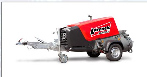
Der EstrichBoy DC 450 STAGE V ist eine zuverlässige, robuste sowie effiziente Estrichpumpe mit hoher Förderleistung von erdfeuchten Estrichen wie Zementestrich, Calciumsulfatetestrich (Anhydrit), Magnesiaestrich und Rüttelboden. Der umweltfreundliche, effiziente und spritsparende DEUTZ-Dieselmotor ist mit einem extra großen 70-Liter-Tank ausgestattet, welcher alle Anforderungen des gültigen
