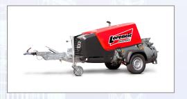
Der EstrichBoy DC 450 STAGE V ist eine zuverlässige, robuste sowie effiziente Estrichpumpe mit hoher Förderleistung von erdfeuchten Estrichen wie Zementestrich, Calciumsulfatestrich (Anhydrit), Magnesiaestrich und Rüttelboden. Der umweltfreundliche, effiziente und spritsparende DEUTZ-Dieselmotor ist mit einem extra großen 70-Liter-Tank ausgestattet, welcher alle Anforderungen des gültigen
