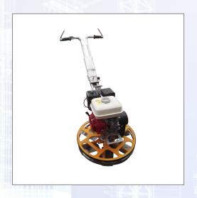
Flügelglätter mit Stabilisierungsring und klappbarem Führungsarm. Speziell konzipiert für das Arbeiten in Ecken. Die 6 Glättflügel gewähren ein schnelles und effizientes Glätten von Beton. Technische Daten: Durchmesser: 600 mm, HONDA Benzinmotor GX160 5,5 PS, Gewicht: 51 kg. Lieferumfang: 1 Glättscheibe d= 600 mm (Art. Nr. Z004110), 6 Finish- Blätter (Art. Nr. Z004205-1).
