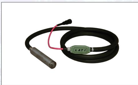
LAIER-Beton-Vibratoren mit 5 m Schutzschlauch, Schalterkasten, 10 m Anschlusskabel und Stecker. Der ausreichend dimensionierte Motor und die besondere Unwuchtkonstruktion garantieren eine dauerhafte Verdichtungsleistung. Schutzspannung von 42 V / 200 Hz. Die Vibratoren arbeiten mit 12000 U/min. Technische Daten: - Länge: 335 mm, - Zentrifugalkraft: 1,75 kN, - 42 V / 200 Hz / 6,4 A, - Gewicht: 10,4 kg.
