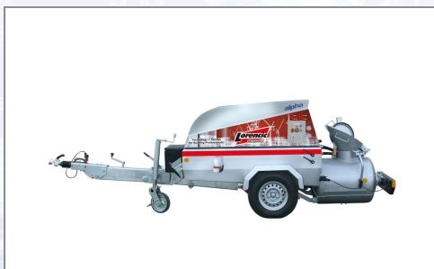
Die BMS ALPHA ENERGY 32A ist vor allem für Estrichleger interessant, die auf Baustellen arbeiten, wo kein Anschluss mit 63 Ampere-Baustellenstrom zur Verfügung steht. Die Elektromaschine lässt sich auf 25 oder 32 Ampere einstellen. Sie kann an alle Baustromverteiler mit einer 400 V / 32 A Drehstromsteckdose angeschlossen werden. Der Kompressor wird mit einem 11 kW Elektromotor angetrieben. Durch den Einsatz eines Frequenzumrichters kann der frequenzgesteuerte
