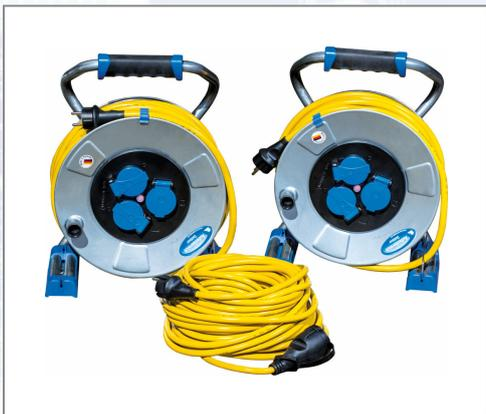
Set bestehend aus: 2x XPERTS-Metallkabeltrommeln mit je 40 m K35 AT-N07V3V3-F 3G1,5 (Nr. 22731), 3 Einbaudosen mit Klappdeckel und Thermoschutz, mit stabilem, stoßdämpfendem X-Doppelrohrgestell mit Sterngriffbremse, ergonomischem, rutschfestem 2-Komponentengriff. Außenbereich IP 44. 1 x 25 m Verlängerungs-Baustellenleitung (Nr. 60355) K35 AT-N07V3V3-F 3G1,5 mit Schutzkontaktstecker u. Schutzkontaktkupplung. Im Polybeutel mit Etikett. Individueller Kundenaufdruck am Kabel kostenlos.
