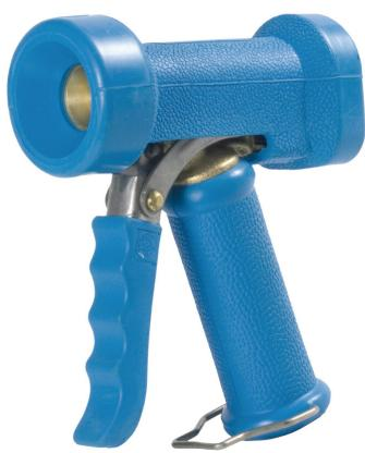
Messing-Gehäuse mit Edelstahlventileinsatz. EPDM-Gummiummantelung der gesamten Pistole zum Schutz gegen Beschädigungen, sowie Kälte- und Wärmeleitung des durchfließenden Wassers. Einhandbetrieb, ergonomisch geformter Handgriff, für Dauerbetrieb arretierbar. Stufenlose Einstellung der Strahlstärke. Wassergeeignet bis 50 °C, Wasserdruck: 24 bar. Anschluss 1/2 " IG. Wasserdurchsatz bei 5 bar 25 l/min.
