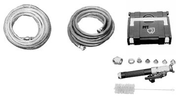
Bestehend aus: - Materialschlauch RONDO d= 25 mm, 15 m, - Luftschauch d= 9 mm, 16 m, Ewo V-Teil/Ewo M-Teil, - 2 Stk Schwammkugeln d= 30 mm fest, - 1 Stk Schwammkugel für RONDO d= 19 mm fest, - Spritzset Oberputz im Koffer bestehend aus: Spritzgerät Oberputze d= 19 mm VA6 100 Ewo mit Luftregulierungsventil und Kugelabsperrhahn, Düsen d= 4,5 / 6,5 / 8,5 / 10,5 mm (Luftbohrung 2 mm), Schlitzdüse mit 2 mm Luftbohrung, Zylinderbürste, Reinigungsdorn.
