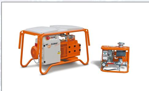
**Funktionsbeschreibung:** Die PFT SILOMAT TRANS PLUS fördert vollautomatisch und staubfrei Trockenmörtel zur Mischpumpe oder zum Durchlaufmischer. Die PFT SILOMAT TRANS PLUS vereint Design und Leistungsfähigkeit. Die Handhabung und der Transport der SILOMAT-Anlage wurde durch viele Helfer vereinfacht, wie zB die integrierten Krantransportösen und ausklappbaren Tragegriffe. Mit ein paar Handgriffen passt das PFT SILOMAT Fördergefäß an jeden Container/Silo. Die PFT
