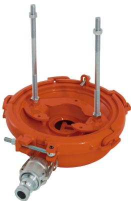
Der PFT ROTOQUIRL II und der ROTOMIX werden als Nachmischer bezeichnet und passen an das PFT-Mischrohr der G 4, G 5 / G 5c und MONOJET. Durch nochmaliges Nachmischen werden die Mörteleigenschaften verbessert und bewirken die max. Ausschöpfung der Materialqualität. Art. Z1180 für Fließestrich, Art. Z1184 für Dämmputze.
