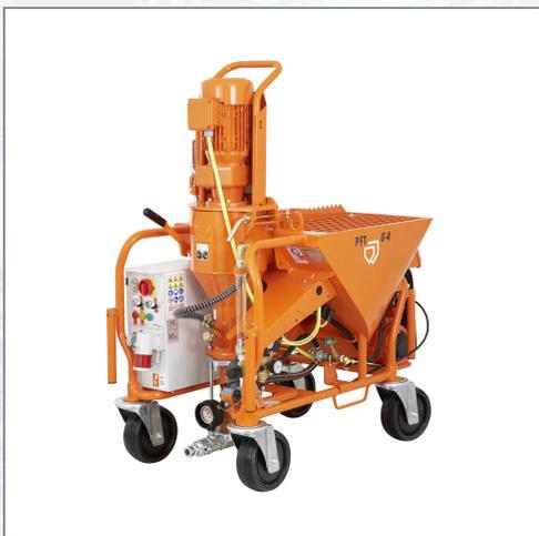
Mischt und pumpt kontinuierlich und vollautomatisch alle maschinengängigen Trockenmörtel mit Wasser zu einem homogenen, verarbeitungsfähigen Nassmörtel. Die Mischpumpe kann sowohl mit Sackware als auch mittels Übergabehaube direkt aus dem Silo oder durch die SILOMAT-Einblashaube pneumatisch befüllt werden. Grundausstattung:
