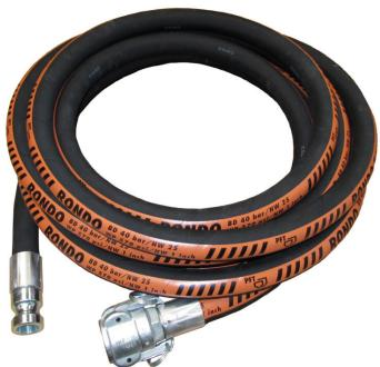
Mörtelschlauch RONDO für die Nassförderung von hochabrasiven Materialien wie Mörtel, Estrich, Putz und Gips geeignet. Eine äußerst glatte, abriebfeste Seele ermöglicht eine sehr hohe Lebensdauer. Der Schlauch ist für einen Betriebsdruck von 40 bar (Platzdruck 120 bar) ausgelegt. Die Kupplungen sind hydraulisch eingebunden, das erhöht die Betriebssicherheit. Zwei Nockenhebel verriegeln die aus Stahl gefertigten und verzinkten Kupplungen.
