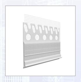
Das Anschlussprofil wird auf das Blech (zB Dachrandabschluss) bis zum Anschlagsteg aufgesteckt und justiert. Das Flächengewebe muss mindestens 10 cm überlappen. Die einzelnen Profile werden mit den beiliegenden Steckverbindern verbunden. Das Armierungsgewebe und die Endbeschichtung sollen bis zur Tropfkante herangeführt werden.
