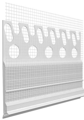
Das Anschlussprofil wird auf das Blech (zB Dachrandabschluss) bis zum Anschlagsteg aufgesteckt und justiert. Das Flächengewebe muss mindestens 10 cm überlappen. Die einzelnen Profile werden mit den beiliegenden Steckverbinder verbunden. Das Armierungsgewebe und die Endbeschichtung sollen bis zur Tropfkante herangeführt werden.
