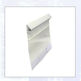
Kunstoffprofil mit Gewebe zum Anschluss an Attika-Abdeckungen bei WDVS- Systemen. Aufgrund des entstehenden Windstaudrucks können durch Wasserhinterwanderung Schäden am WDVS-System eintreten, die mit dem Attikaprofil verhindert werden können.
