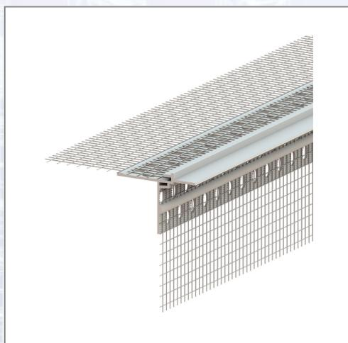
Kunststoffprofil zum sauberen An- bzw. Abschluss am Parapet. Der horizontale Kunststoffschenkel mit verschweißtem Gewebe ist in der notwendigen 5 ° Gefälleneigung ausgebildet. Das Regenwasser wird somit über die zweite Dichtebene gezielt nach vorne abgeleitet. Die Tropfkante sowie die passgenauen Eckstücke verhindern Verschmutzungen an der Fassade.
