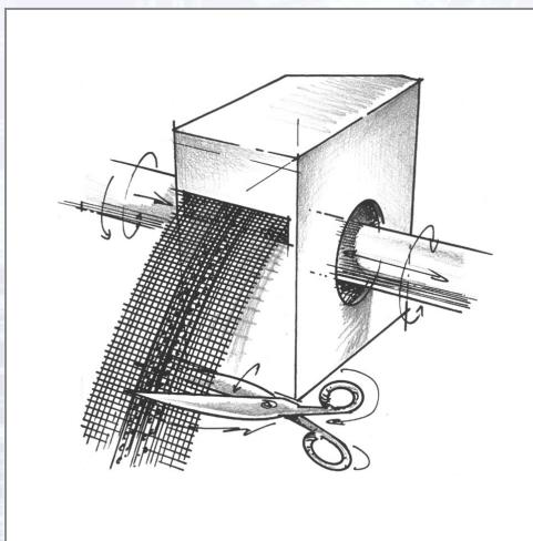
Kunststoffprofil mit aufkaschierterem VWS-Gewebe als Richthilfe zur sauberen Ausbildung von Gebäudeecken. PVC-Rolleckwinkel flexibel m. WDVS-Gewebe, Schenkelbreite 125x125 mm, 50 Ifm/Rolle 1 Roll/Kart 30 Kart/Pal.
