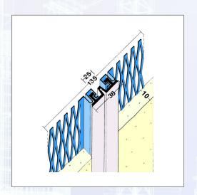
Dehnfugenprofil aus verzinktem Stahlblech für Putzflächen. Der Mittelteil besteht aus einer Kombination aus Hart- und Weich-PVC. Bewegungsaufnahme: Zug/Druck: +5/-2 mm. An feuchte- und wasserbelasteten Flächen nur senkrecht einsetzen. Im Stoßbereich PVC-Überzug überlappend anordnen.
