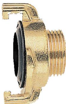
Kupplung aus Messing, mit Mehrzweck-Gummi-Druck- und Saugdichtung. Einheitliche Nockenwelle von 40 mm (Kombination von Schlauch- und Gewindestücken 3/8 " bis 6/4 " untereinander möglich). 10 bar Betriebsdruck, für Wasser und Druckluft.
