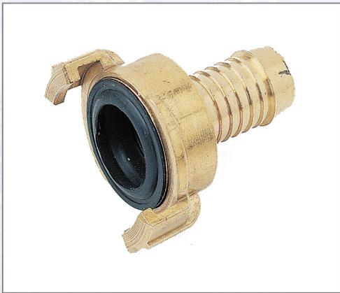
Kupplung aus Messing, mit Mehrzweck-Gummi-Druck- und Saugdichtung. Einheitliche Nockenwelle von 40 mm (Kombination von Schlauch- und Gewindestücken 3/8 " bis 6/4 " untereinander möglich). 10 bar Betriebsdruck, für Wasser und Druckluft.
