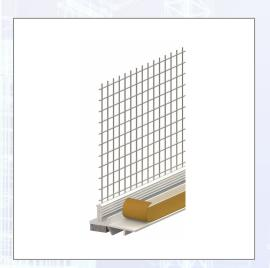
Laibungsanschlussprofil 10 mm mit Dichtlippe und Gewebe. Schlagregendicht nach DIN EN 1027, PE-Dichtband 3 mm, Verarbeitungstemperatur +5° bis +40°C. Klassifizierung nach ÖAP- Richtlinie Klasse 1B.
