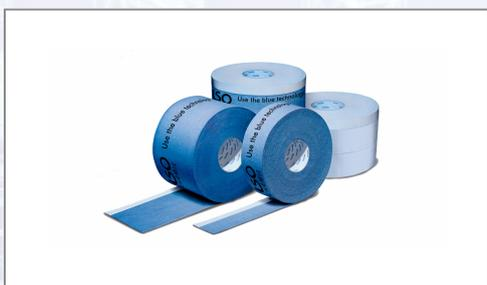
ISO-CONNECT INSIDE FD ist eine extrem flexible und dehnfähige Spezialfolie für die luft- und winddichte Abdichtung von Anschlussfugen bei Fenstern, Türen und Paneelen. Kein Wassereintritt bis 1050 Pa, sd-Wert ca. 39 m. Sie besteht aus einem anpassungsfähigen weichen Kunststoffvlies, welches mit einem Selbstklebestreifen für eine schnelle und rationelle Montage am Fensterrahmen ausgestattet ist. Die dampfdiffusionsgeschlossene Vliesfolie sorgt für eine sichere
