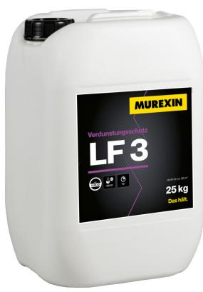
Lösungsmittelfreies, sprühfähiges, rasch wirksames, ergiebiges, abwitterndes Nachbehandlungsmittel mit hoher Sperrwirkung gegen vorzeitige Wasserverdunstung. Im Innen- und Außenbereich, zur Nachbehandlung von frisch hergestelltem Beton und Zementmörtel vor zu rascher Austrocknung bei Sonnen- und Windeinwirkung. Verbrauch: ca. 0,15–0,20 kg/m<sup>2</sup>.
