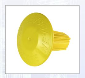
Die NEVOSAFE-PLUS Schutzkappe mit Stahleinlage sitzt fest und stabil aufgrund der Rippenkonstruktion auf jeder Anschlussbewehrung, schützt sicher und zuverlässig bei einem Sturz aus 3 m Fallhöhe mit 100 kg. Mehrfach wiederverwendbar. 110 mm Durchmesser für die bessere Schutzwirkung.
