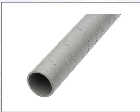
Als Mauerstärken - Abstandhalter für die senkrechte Schalung. Durch die gerillte Oberfläche haben die Rohre im Beton einen besseren Halt. Die benötigten Längen können schnell durch Ablängen des Abstandrohres vor Ort hergestellt werden. Material: PVC, frei von FCKW, HFKW, ohne besonders besorgniserregende Stoffe gemäß REACH-Verordnung.
