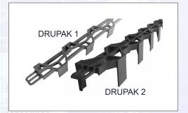
Großflächiger und besonders stabiler Abstandhalter, vorwiegend für die untere Bewehrung. Hergestellt aus 100 % recyceltem, PVC-freiem Kunststoff. Besonders guter Betondurchfluss durch große, seitliche und obenliegende Aussparungen. Für Sichtbeton und Elementdecken nur bedingt geeignet. DRUPAK 1: Breite 36 mm. Aufgrund besserer Kippstabilität empfehlen wir ab Betondeckung 40 mm DRUPAK 2 (Breite 46 mm).
