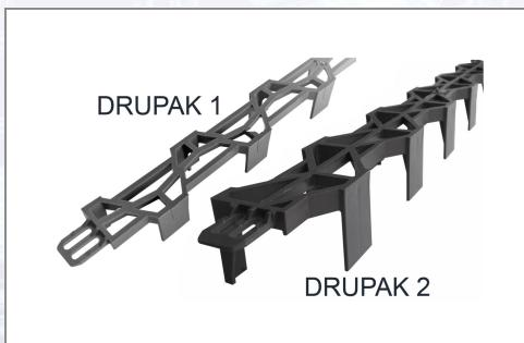
Großflächiger und besonders stabiler Abstandhalter, vorwiegend für die untere Bewehrung. Hergestellt aus 100 % recyceltem, PVC-freiem Kunststoff. Besonders guter Betondurchfluss durch große, seitliche und obenliegende Aussparungen. Für Sichtbeton und Elementdecken nur bedingt geeignet. DRUPAK 1: Breite 36 mm. Aufgrund besserer Kippstabilität empfehlen wir ab Betondeckung 40 mm DRUPAK 2 (Breite 46 mm).
