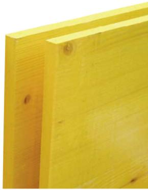
Holzart: 3 miteinander wasserdicht verleimte Schichten, hergestellt aus Fichte/Tanne-Lamellen. Die Verleimung ist wasser- und witterungsbeständig lt. EN 13353 (SWP/3). Qualität gemäß ÖNORM B 3023. Konstruktion: 6,3 mm Außenschicht, Mittelschicht 14,0 mm (8,3 mm für 21 mm Dicke). Oberfläche: Heiß-Imprägnierung mit Melaminharz, Farbe gelb.
