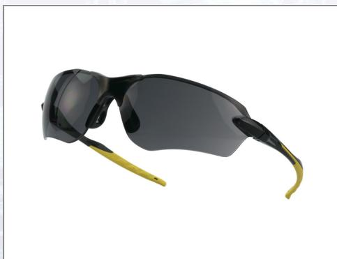
Schutzbrille TECTOR® gemäß EN 166, Sichtscheibe aus Polycarbonat. Bügel: schwarz/gelb, Sichtscheibe: grau getönt. Antikratzbeschichtet, sportliches Design, Bügel höhenverstellbar. Elastische Brillen- und Nasenbügel für angenehmes Tragegefühl. Gewicht: ca. 22 g.
