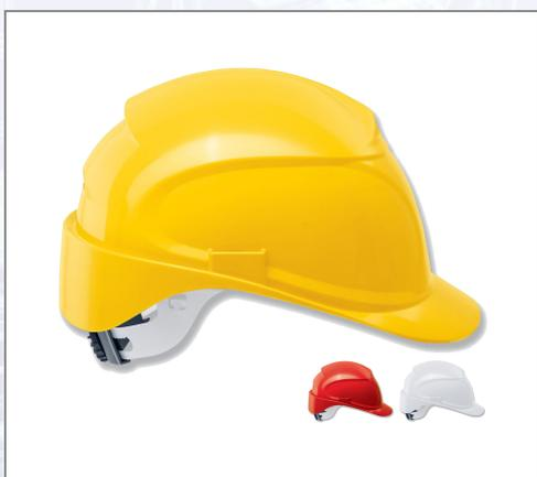
Neuer leichter Schutzhelm mit 3 variablen Ventilationsöffnungen, eine im Stirn- sowie zwei im Hinterkopfbereich. Ausgestattet mit Schweißband. - 6-Punkt-Textilbandaufhängung gewährleistet optimale Passform und Komfort, - seitliche Euroslot-Aufnahmen (30 mm) für die Montage von Gehörschutzkapseln oder Visieren, - Drehradsystem für eine stufenlose Weitenregulierung, - Norm EN 397: Zusatzanforderungen für sehr niedrige Temperaturen (-30 °C), - Einstellbereich: 52-61 cm, - Gewicht: 440 g.
