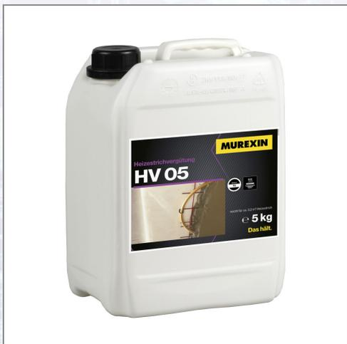
Flüssiges, chloridfreies, verflüssigend wirkendes Zusatzmittel für zementgebundene Heizestriche. Zur Estrichvergütung bei Fußbodenheizung ohne Luftporeneinführung sowie zur Plastifizierung und damit verbundener leichterer Verarbeitung. Verbessert die Heizrohrummantelung. Nur im Innenbereich anwenden. Verbrauch: 0,5 % vom Zementgewicht (ca. 2 kg/m<sup>3</sup> Beton).
