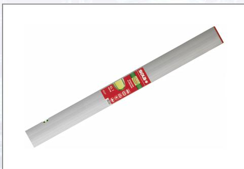
Alu-Rohrprofil mit Mittelsteg, mit 1 Waagrechtlilbelle. Dimensionen ca. 100x18 mm, 870 g/lfm. Entgratetes Profil, daher keinerlei Verletzungsgefahr, bruchfeste Acrylglas-Blocklibellen und stoßdämpfende Endkappen. Maximale Messtoleranz in Standardposition 0,75 mm/m (0,043 °).
