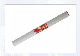
Alu-Rohrprofil mit Mittelsteg, mit 1 Waagrechtlibelle. Dimensionen ca. 100x18 mm, 870 g/lfm. Entgratetes Profil, daher keinerlei Verletzungsgefahr, bruchfeste Acrylglas-Blocklibellen und stoßdämpfende Endkappen. Maximale Messtoleranz in Standardposition 0,75 mm/m (0,043°).
