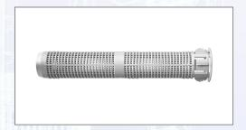
Für eine kontrollierte Montage im Lochbaustoff wird eine Siebhülse verwendet. Die Montage der Siebhülse erfolgt bündig mit dem Baustoff, die Siebhülse wird vollständig mit Injektionsmörtel aufgefüllt. Anschließend wird eine Gewindestange (RG-M) in die Siebhülse gesteckt, der Mörtel wird durch die Gitterstruktur der Ankerhülse gedrückt und passt sich dem Verankerungsgrund optimal an (Formschluss).
