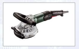
Zum effektiven Anschleifen und Abtragen von Beton, Estrich und Beschichtungen mit Diamanttopfscheiben. Hohes Drehmoment und Überlastfähigkeit für harte Anwendungen im Dauereinsatz. Randnahes Arbeiten durch unverlierbares Segment zum Aufklappen. Elektronischer Sanftanlauf für ruckfreies Anlaufen. Geringes Gewicht, ideal zum Schleifen im Wand- und Deckenbereich. Technische Daten: - Nennaufnahmeleistung: 1900 W, - Abgabeleistung: 1240 W, - Drehzahl bei Nennlast:
