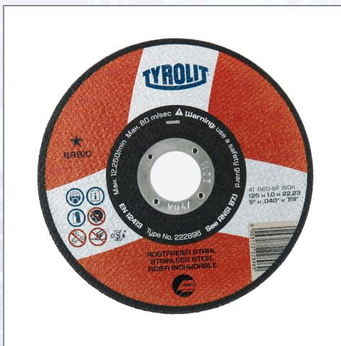
Superdünne Trennscheiben (gerade) für saubere Schnittflächen, geringste Gratbildung bei Profilen, Rohren, Blechen, Stahlseilen, Kabeln. Kurze Trennzeiten: extreme Schnittigkeit und geringe thermische Belastung am Werkstück. Minimum an Schnittabfall durch geringe Scheibenbreite. Präzises Arbeiten: exakte, maßgenaue Schnitte, kein Schnittverlauf. Vs = 80 m/sec, Kunstharzbindung, Faserstoffverstärkung.
