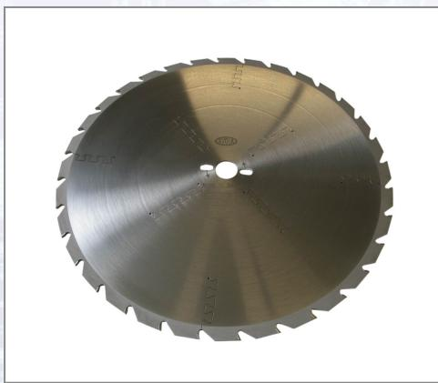
Das Hartmetall-Sägeblatt, nagelfest und schallgedämpft, für Baukreissägen - zur Verwendung von groben Brenn- und Bauholzschnitten. Unempfindlich gegen Betonreste und bedingt nagelsicher (nicht geeignet für Stahlnägel etc.). Das Stammbrett hat eine Stahlgüte von C75. Bohrung 30 mm.
