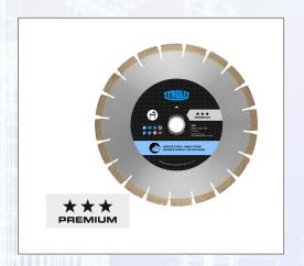
Diamant-Nassschnittsägeblätter für Bearbeitung von Granit, Hartbrandklinker und hart gebrannter Ziegel. Enge Verzahnung für saubere Schnittkanten, Reduzierringe auf 30/25,4 mm beigepackt.
