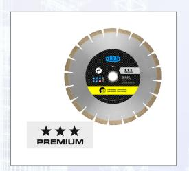
Diamant-Nassschnittsägeblätter für Tischsägen sind universell einsetzbar für Waschbeton, Betonstein, Kalkstein hart, Ziegel weich etc. Bei allen Tischsägeblättern sind Reduzierringe von 35 auf 30 mm bzw. 25,4 mm beigepackt. Ab Durchmesser 625 mm werden Reduzierringe von 60 auf 55 mm mitgeliefert. Geräuschgedämpftes Stammblatt in Sandwichbauweise.
