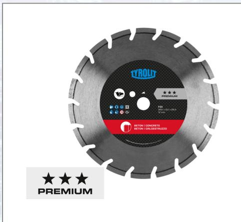
Premium-Fugenschnittblatt C7W (FSC) für den Einsatz in Maschinen mit Leistung bis 15 kW. Bearbeitbare Materialien: Altbeton mit weichen bis mittelharten Zuschlägen. Lasergeschweißt. Messbohrung zur Verschleißkontrolle.
