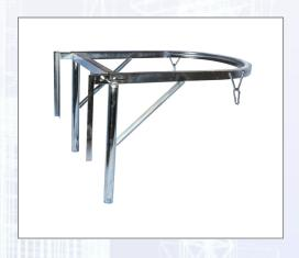
Der Brüstungsrahmen ist für die Befestigung am Gerüst oder zum Einhängen an Fensterbrüstungen etc. vorgesehen. Bis ca. 48 cm verstellbar. Das erste Rohr der Bauschuttrutsche muss fest gesichert werden! Eine Befestigung/Verankerung der Rutsche an jedem zehnten Rohr am Gebäude bzw. Gerüst ist unbedingt erforderlich! Das Gesamtgewicht der Bauschuttrutsche darf 250 kg nicht überschreiten. Das untere Rutschende leicht krümmen, um die Fallgeschwindigkeit des Schutts
