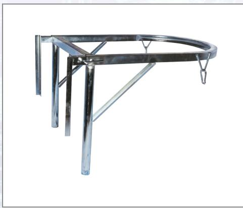
Der Brüstungsrahmen ist für die Befestigung am Gerüst oder zum Einhängen an Fensterbrüstungen etc. vorgesehen. Bis ca. 48 cm verstellbar. Das erste Rohr der Bauschuttrutsche muss fest gesichert werden! Eine Befestigung/Verankerung der Rutsche an jedem zehnten Rohr am Gebäude bzw. Gerüst ist unbedingt erforderlich! Das Gesamtgewicht der Bauschuttrutsche darf 250 kg nicht überschreiten. Das untere Rutschende leicht krümmen, um die Fallgeschwindigkeit des Schutts zu verlangsamen.
