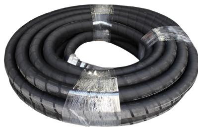
Hochabriefester Förderschlauch aus Gummi mit Textilcordeinlage für die Förderung von Gips, Kalk- und Zementemulsionen. Beidseitig eingebundene Storz-C/45-Saugkupplungen aus Aluminium mit Schellen aus Edelstahl DN 45, 10 bar. - Betriebsdruck des Schlauches: 10 bar, - Temperaturbereich: -30 °C bis +80 °C, - Innendurchmesser: 45 mm, - Wandstärke: 7 mm.
