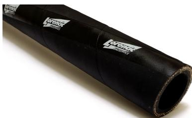
Dorngefertigter Druckschlauch geeignet zur Durchleitung von Mörtel, Estrich, Verputz, Beton, Gips und sonstigen nassen, abrasiven Medien. Eingesetzt auf Spritzbeton-Maschinen, im Tunnelbau und in öffentlichen Werken. Technische Daten: - Seele: schwarzer, glatter Gummi, antistatisch, abriebfest. - Einlagen: synthetische Textileinlagen. - Decke: schwarzer, glatter Gummi, abrieb- und witterungsbeständig, stoffgemustert. - Betriebsdruck: 10 bar. - Soll-Platzdruck: 30 bar. -Temperatur: -40 °C +70 °C.
