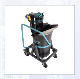
Der mobile Fließmassenmischer LevMix mischt optimal Spachtelund Ausgleichsmassen. Das hoch effektive Mischpaddel verhindert die Klumpenbildung, das Material wird vollständig erfasst, es verbleibt kein Bodensatz. Das Umfüllen in einen Transporteimer ist nicht notwendig, bis zu 50 % weniger Mischzeitaufwand als beim manuellen Mischen. Technische Daten: - Mischbehälter: 75 Liter, - Nutzmenge: 55 Liter, -Mischwerk: 1,6 kW, 230 V, - Drehzahl Mischwerk unter Last: 410 UpM, - Gewicht: 42 kg.
