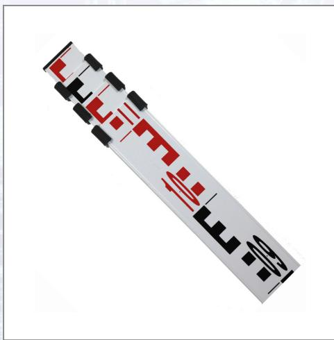
Aus eloxierten Aluminiumprofilen teleskopartig ausziehbar. Teilung beidseitig. Vorderseite E-Teilung, Rückseite mm-Teilung zum Messen von Höhen oder Längen. Leichte und genaue Führung der einzelnen Elemente. Druckknopfrasterung. Mit Aufstecklibelle, in Transporthülle.
